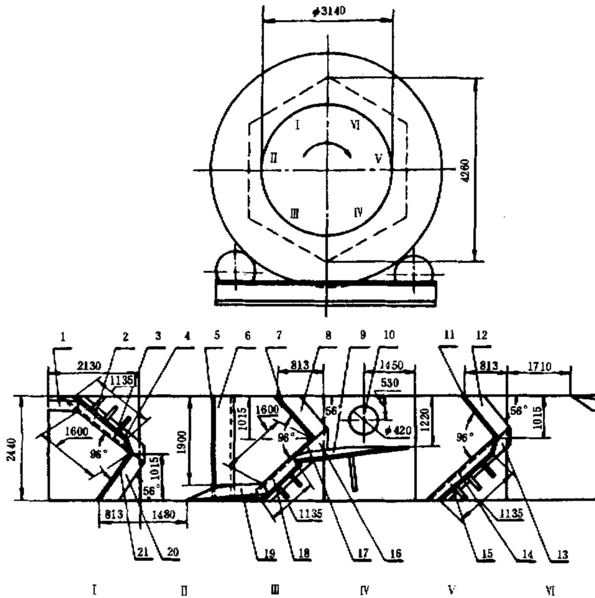
图 2 4260 型六角滚筒试验机结构尺寸示意图
