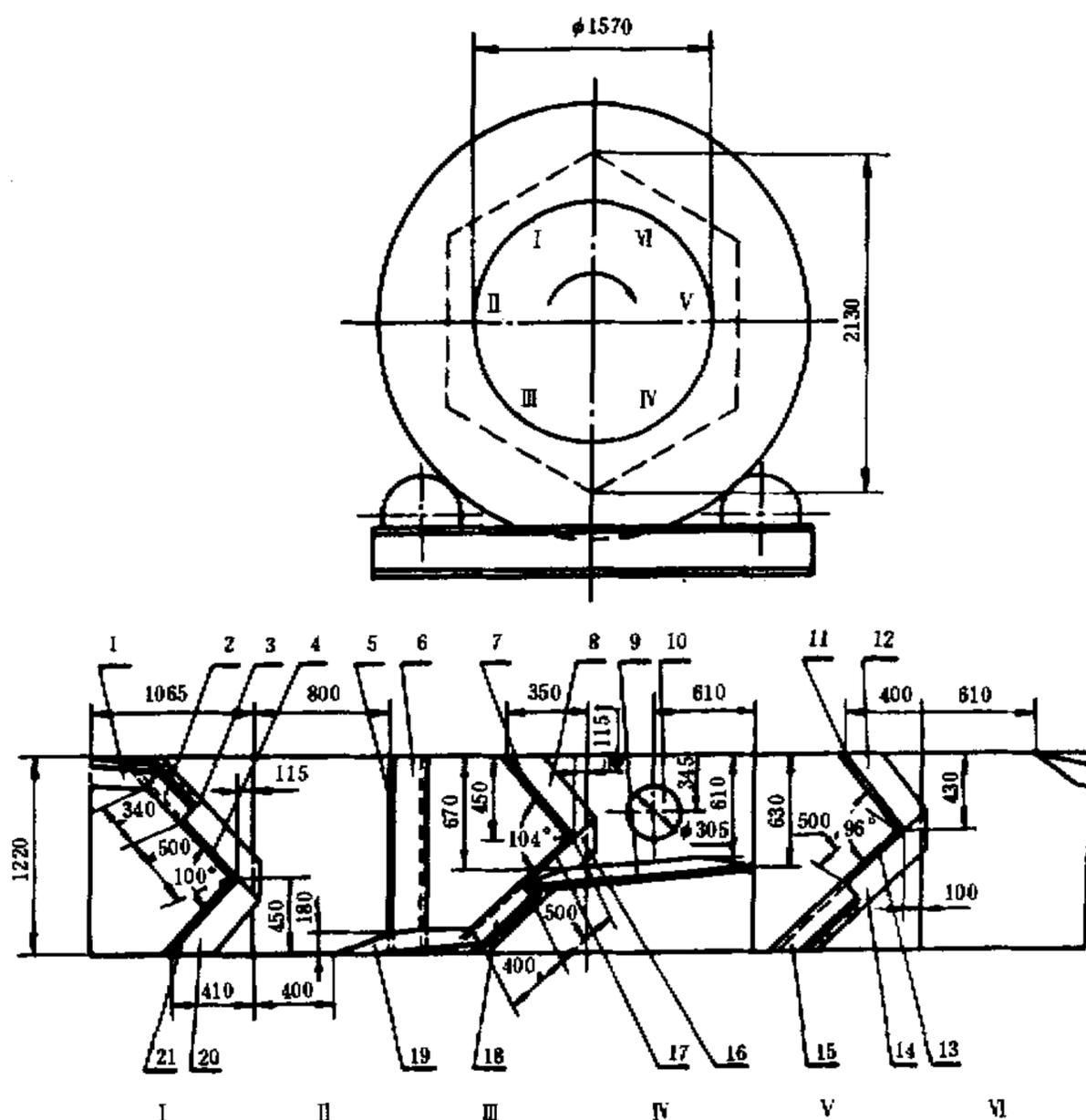
图 1 2130 型六角滚筒试验机结构尺寸示意图
